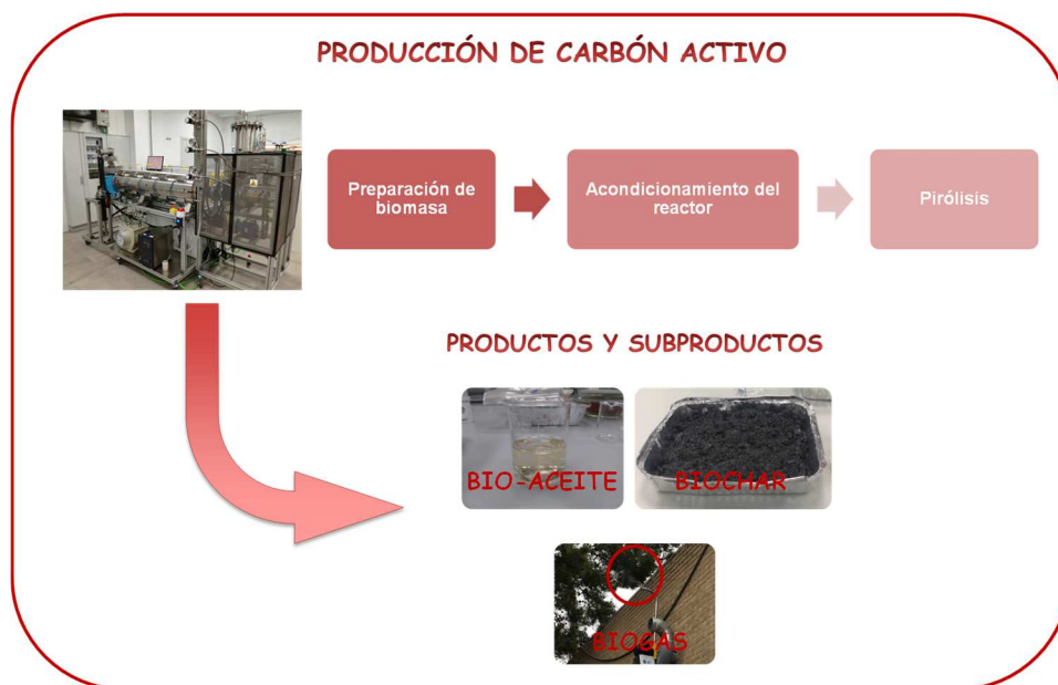
Figura 3. Esquema del proceso de producción de carbón activado en la planta de pirólisis lenta CIRCULARCARBON. Fuente: ITE
