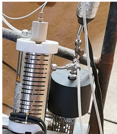
Figura 27. Esquema de inyección de CHOH a la corriente de gases procedente de la chimenea de humos de la etapa de cocción de baldosas cerámicas
